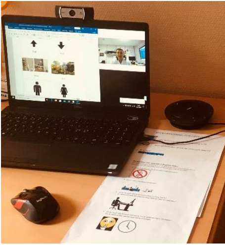
Bilde 1: Teknisk oppsett pasient PC med Logitech C930 webkamera og Jabra mikrofonhøytaler.
